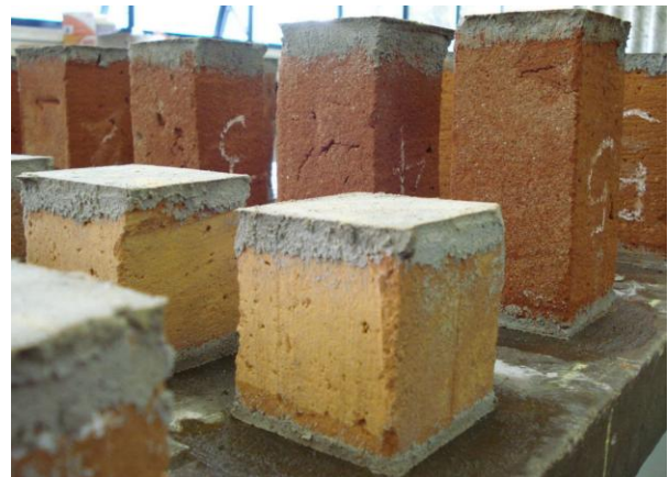
Figura 3. Especímenes cúbicos y prismáticos preparados para las pruebas
