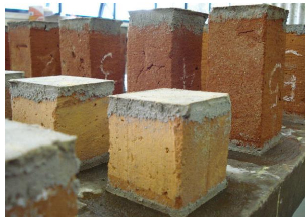
Figura 3. Corpos de prova cúbicos e prismáticos, preparados para os ensaios
